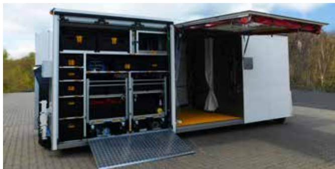
Moduł do dekontaminacji i higieny dla służb ratowniczych zgodnie z DIN 14505
